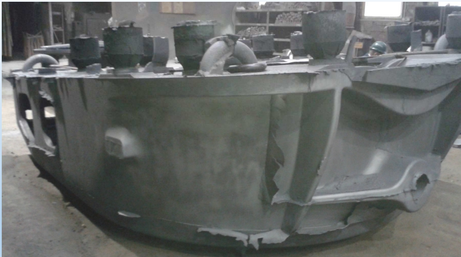
Rama główna do elektrowni wiatrowej 2,5MW, materiał EN-GJS-400-18U-LT, waga odlewu surowego 19,7 tony
