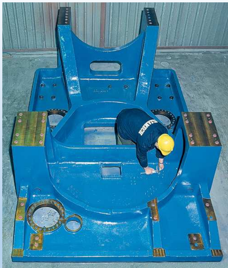
Rama generatora do elektrowni wiatrowej 1,3MW Waga odlewu surowego 12,9 tony
